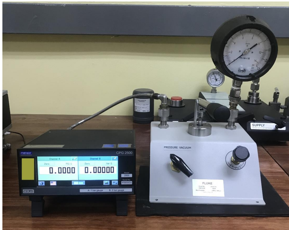
Figura 1: Montaje para calibración de manómetro análogo con patrón de referencia digital
