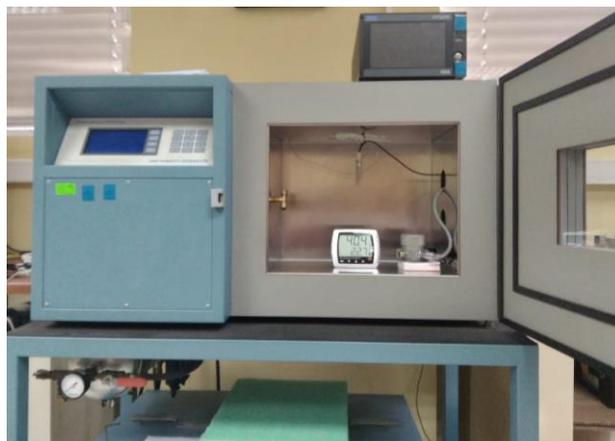
Figura 3. Montaje para la calibración del patrón viajero.
