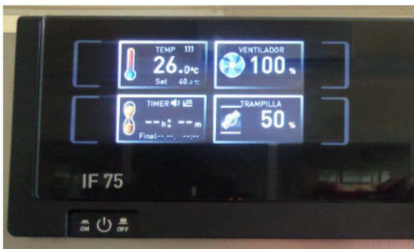
**Figura 1:** Configuración requerida para las variables “VENTILADOR” y “TRAMPILLA” para la caracterización de la Incubadora Memmert.
