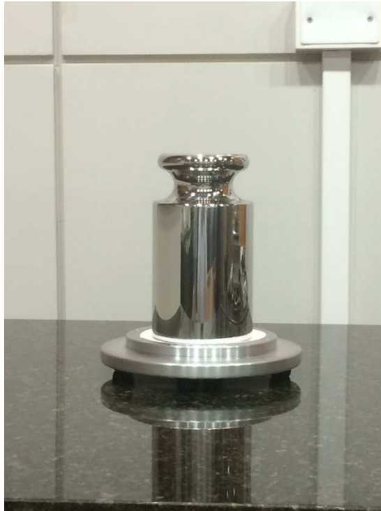
Figura 2. Fotografía en vista lateral de la pesa de 10 kg. Esta pesa satisface los requisitos de fabricación de OIML para la clase E2.
