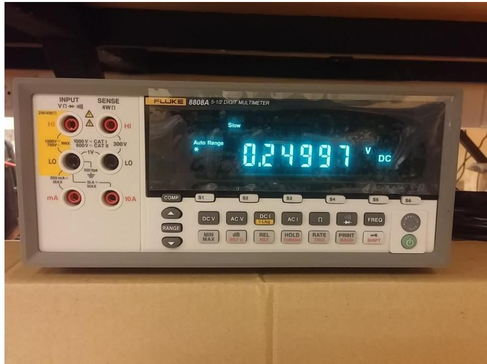
2.2. El instrumento se puede configurar en 5 ½ dígitos y 4 ½ dígitos, que serán las configuraciones de medición que se usaran en esta ronda.
