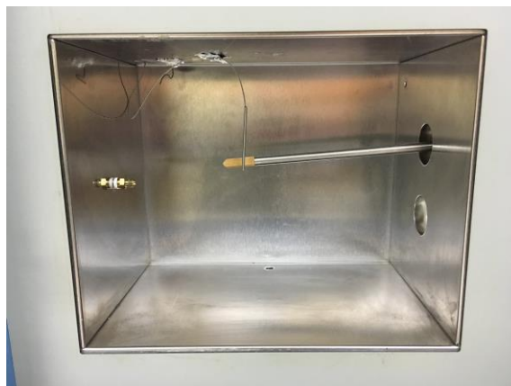
Figura 2. Montaje del sensor al interior de la cámara útil.
