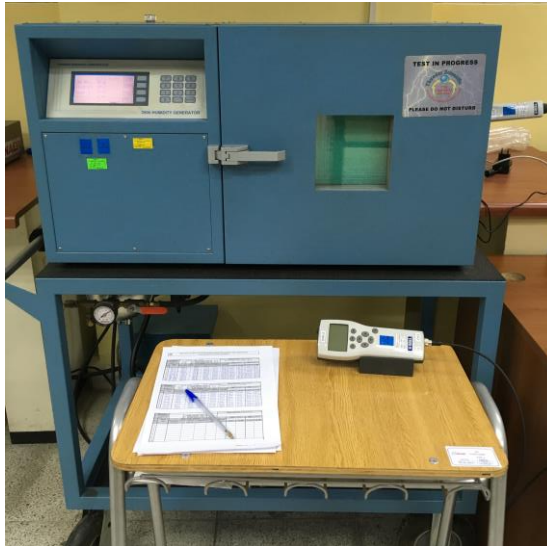
Figura 2. Montaje para la calibración del patrón viajero.
