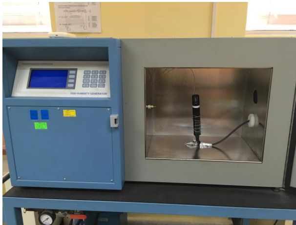
Figura 2. Montaje para la calibración del patrón viajero.
