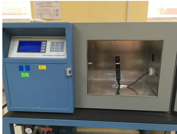
Figura 2. Montaje para la calibración del patrón viajero.
