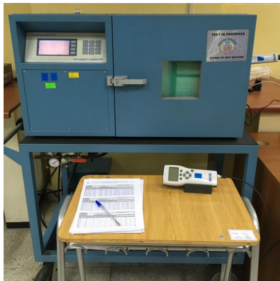
Figura 2. Montaje para la calibración del patrón viajero.
