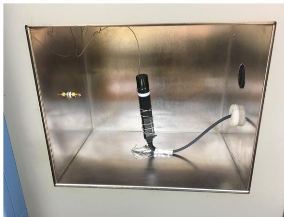
Figura 2. Montaje del sensor al interior de la cámara útil.
