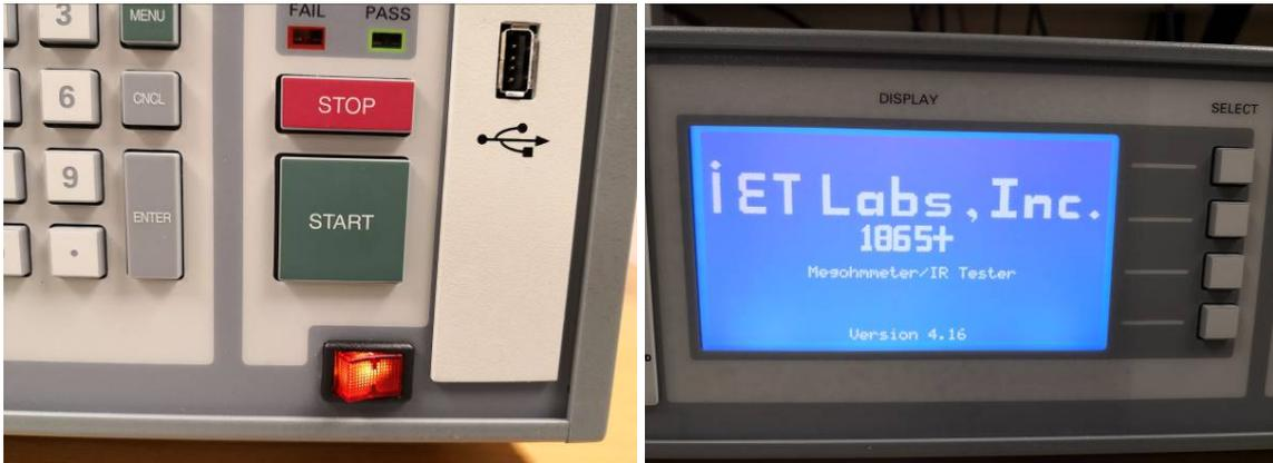
Una vez encendido se debe presionar el botón MENU para acceder al menú del instrumento para poder setear los parámetros de medición.
