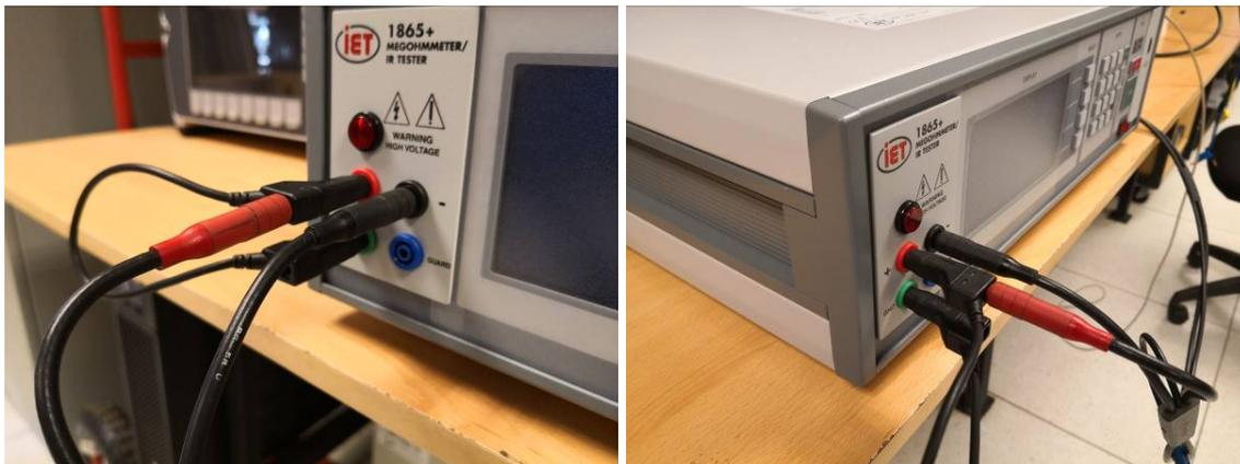
La conexión se hará realizando un corto circuito el HIGH (Rojo) con el borne GND (Verde) y luego el cable proporcionado para la medición se conectará entre el HIGH (Rojo) y el LOW (Negro). El cable usado para el corto circuito también es proporcionado.
