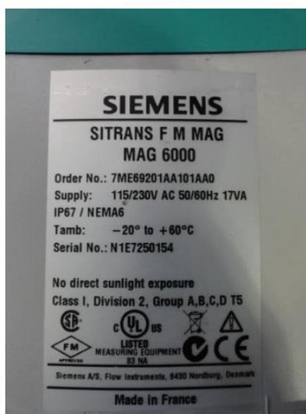
Foto 2: Detalle de la placa del transmisor
