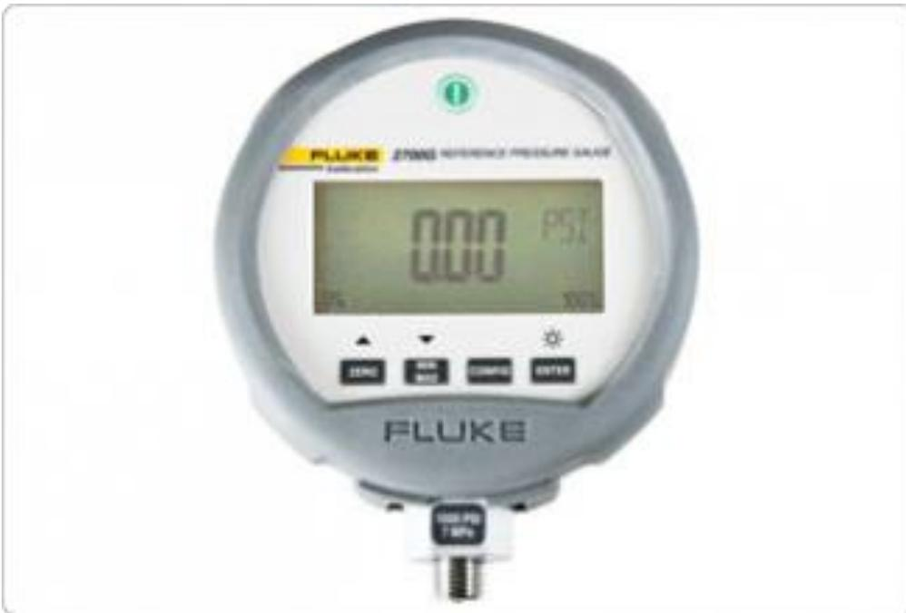
**NOTA:** Indicador de presión digital de 0 MPa a 20 MPa puede indicar en diferentes unidades de presión, para los efectos de ésta comparación la unidad será MPa.
