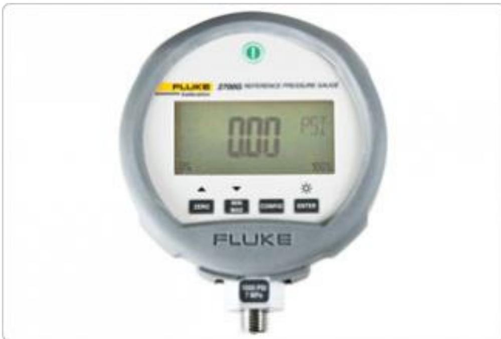
**NOTA:** Indicador de presión digital de -90 kPa a 0 kPa puede indicar en diferentes unidades de presión, para los efectos de ésta comparación la unidad será kPa.
