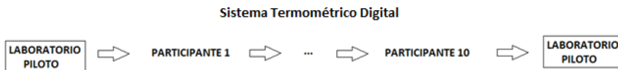
Figura 1: Configuración mediciones del EA T19-2.
