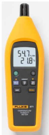
Figura 2. Patrón viajero usado en la comparación H-20 para participantes con cámara climática
