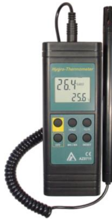
Figura 2. Patrón viajero usado en la comparación H-20 para participantes con sales higroscópicas
