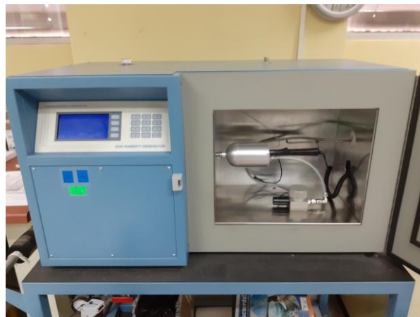
Figura 3. Montaje para la calibración del patrón viajero.
