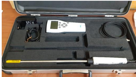
Figura 2. Patrón viajero usado en la comparación H-21 para participantes con cámara climática.
