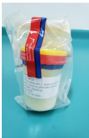
Figura N°1. Material de ensayo en envase plástico estéril, etiquetado y codificado.
