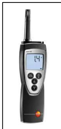
Figura 2. Patrón viajero usado en la comparación HRc-23 para participantes con cámara climática.
