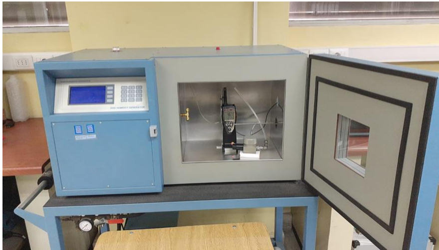
Figura 3. Montaje para la calibración del patrón viajero.
