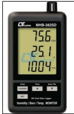
Figura 2. Patrón viajero usado en la comparación HRs-23 para participantes con sales higroscópicas
