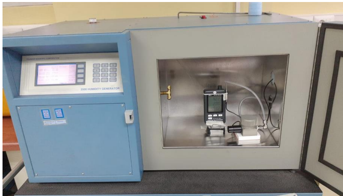
Figura 3. Montaje para la calibración del patrón viajero.
