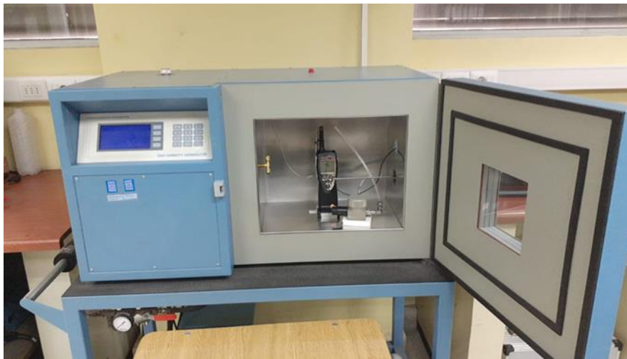
Figura 3. Montaje para la calibración del patrón viajero.
