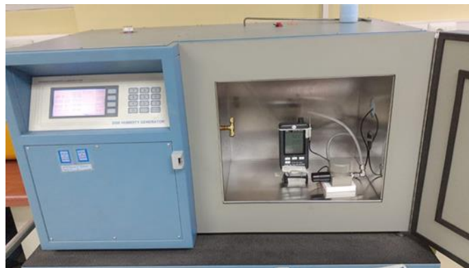
Figura 3. Montaje para la calibración del patrón viajero.
